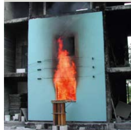
1. A vizsgálat során a többszáz fokos lángok a felső ablakon is túlnyúlnak
