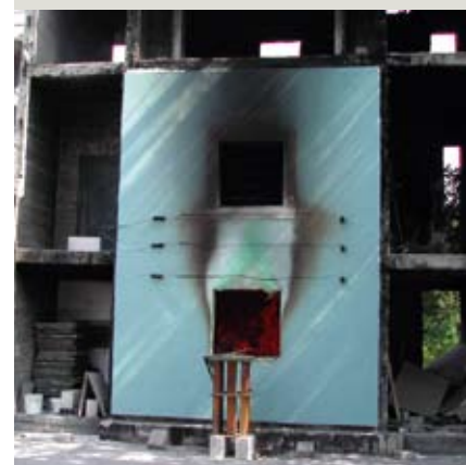
2. A vizsgálat végén a vakolat egybefüggő maradt
