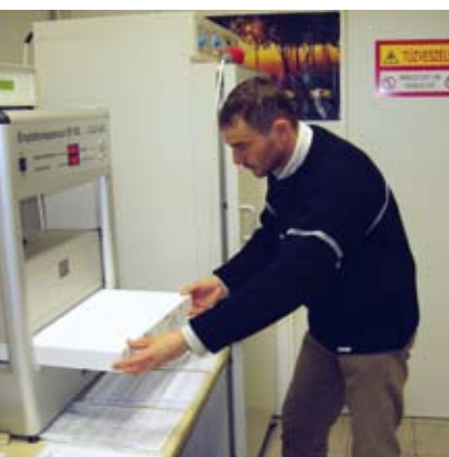
Hővezetési tényező mérése
